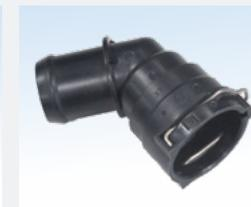
従来のクランプ留めや樹脂チューブへの圧入などが不要で、相手部品に差し込むだけで組み付けできます。作業を容易にするほか、組付時の締結音により、目視できない場所でも確実な締結が可能です。
